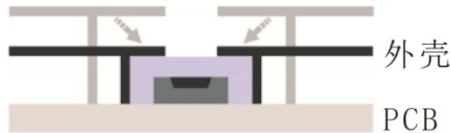
图12. 测量盲区小有利于传感器快速全方位检测到环境变化。
