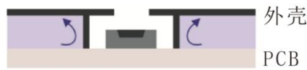
图11. 传感器与外壳内部空气进行隔离，将外壳内部密闭空气对传感器的影响降到最低。
